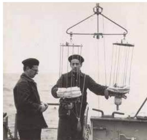
В.Г. Богоров и Е.И. Кудинов готовят к работе планктоно-собираетель Богорова на НИС «Витязь». 2-ой рейс. 1949
