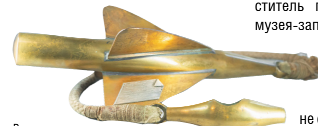
Вертушка лага, который отсчитал первые 10 тыс. миль исследовательского плавания НИС «Витязь»
